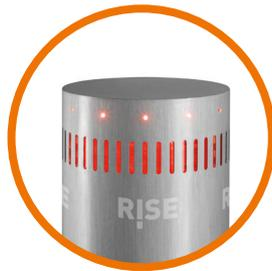
I dissuasori fissi con corona luminosa sono dotati di 12 LED rossi ad alta visibilità con 5 diverse modalità di lampeggio selezionabili mediante dip-switch. Devono essere alimentati a 24Vdc.
